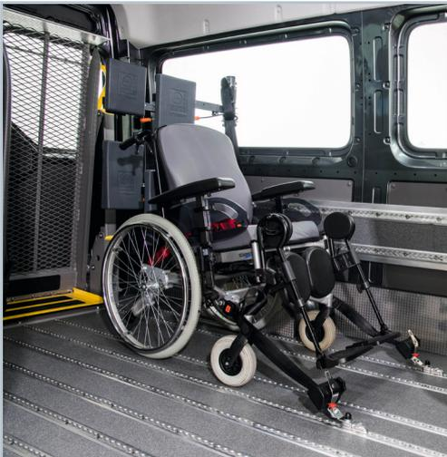
Über den Lift gelangt der Rollstuhl in das Fahrzeug; das AMF-Brunns PROTEKTOR System sichert Person und Rollstuhl.
